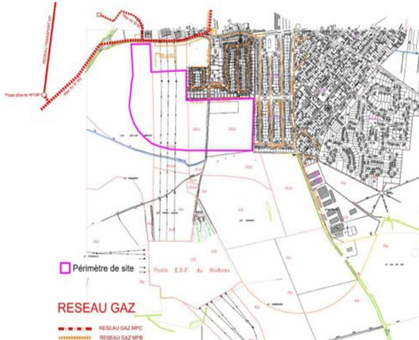
Illustration 52 : Plan des réseaux de distribution de gaz à proximité du projet (source SETU, 2013)
